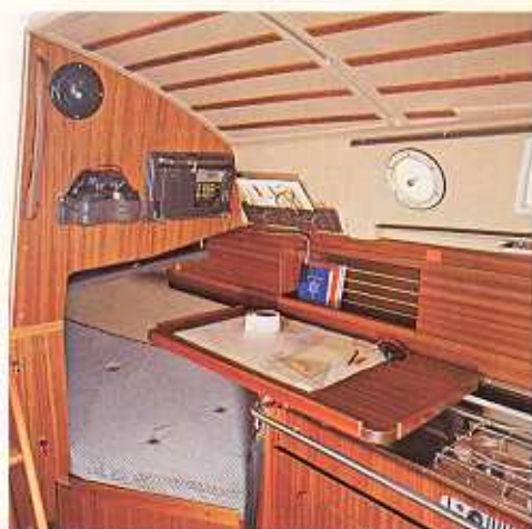
Die große Abdeckplatte der Pantry dient dem Navigator gleichzeitig als Kartentisch. Unter dem Cockpitsüll ist das Kartenfach, im Schiebeschrank ist Platz für nautische Literatur.
